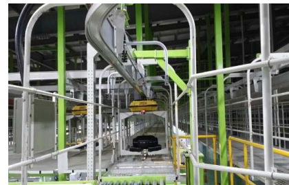
한국타이어 - 중국 / 미국공장 Tire 이송 천정 주행 장치 시스템
