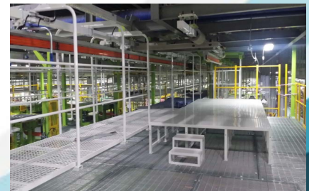
한국타이어 - 중국 / 미국공장 Tire 이송 천정 주행 장치 시스템
